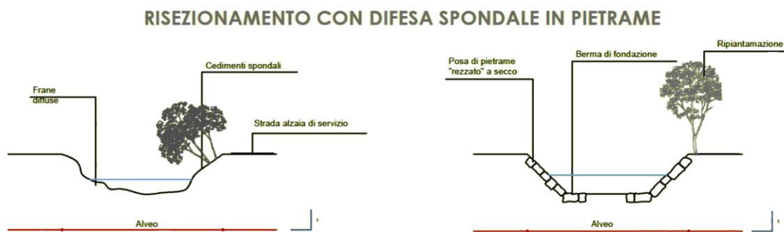
Figura 39. Interventi di risezionamento sul Colatore Addetta
