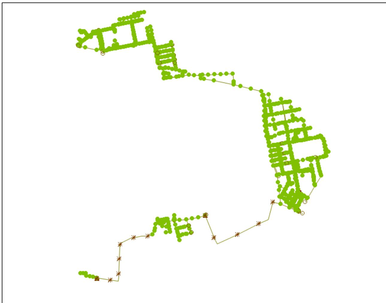
Figura 18. Schema rete fognaria del comune di Mediglia, porzione ovest. Fonte Infoworks.
