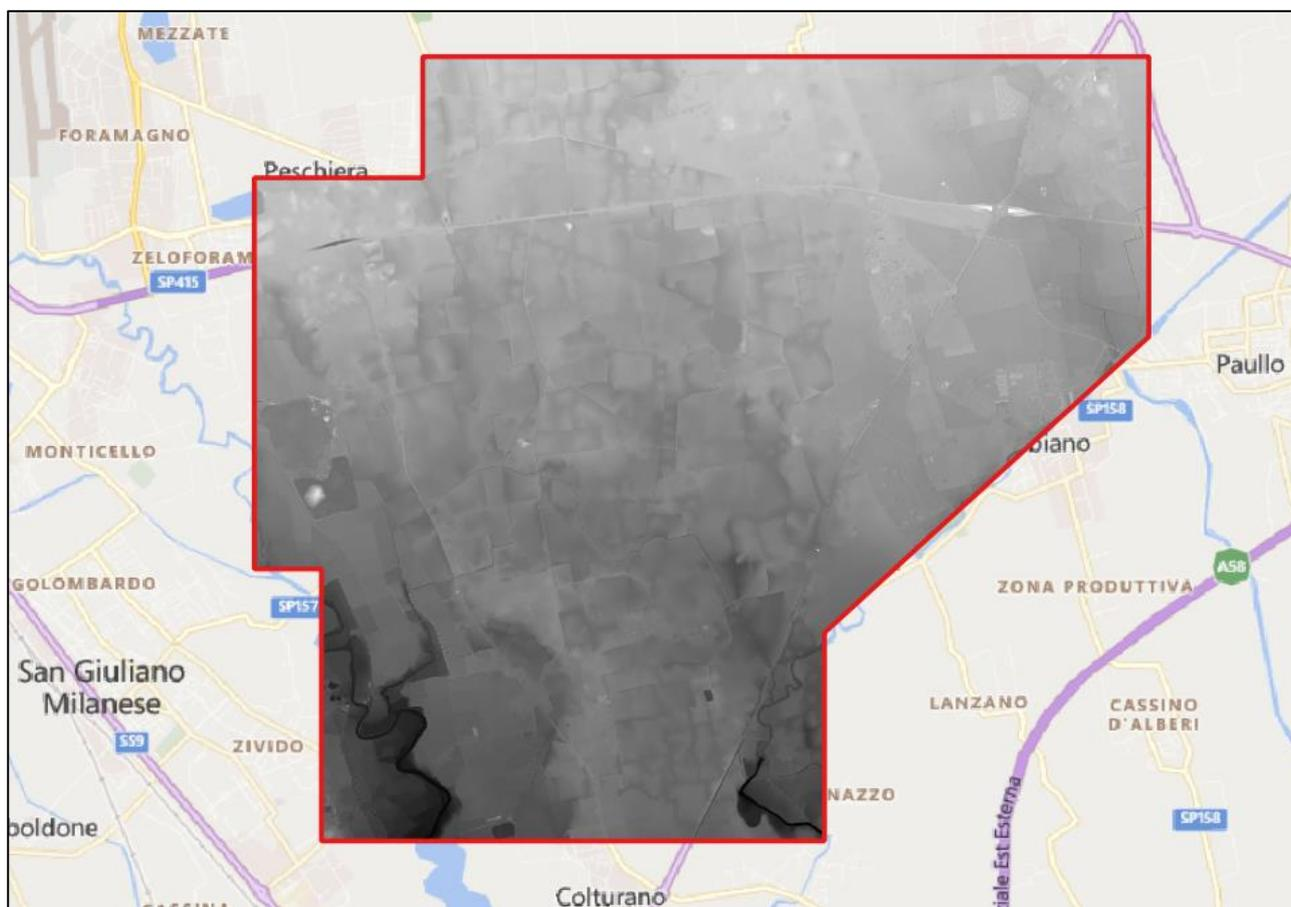
Figura 30. DTM utilizzato nella modellazione bidimensionale. Unione fra LIDAR 1x1 e DTM 5x5. In rosso evidenziato il dominio di calcolo del modello bidimensionale.
