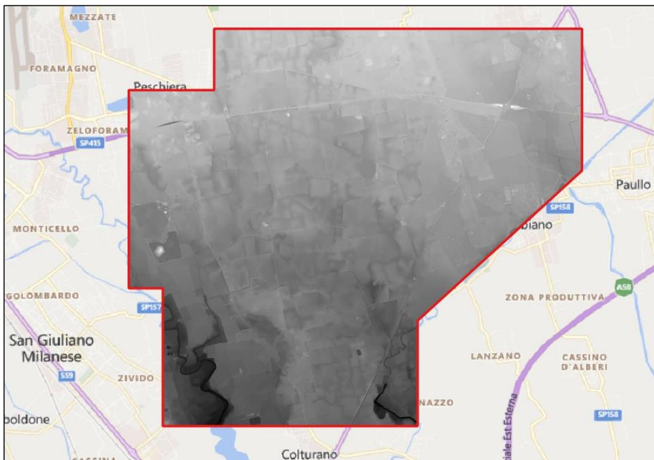
Figura 16. DTM utilizzato nella modellazione bidimensionale. Unione fra LIDAR 1x1 e DTM 5x5. In rosso evidenziato il dominio di calcolo del modello bidimensionale.
