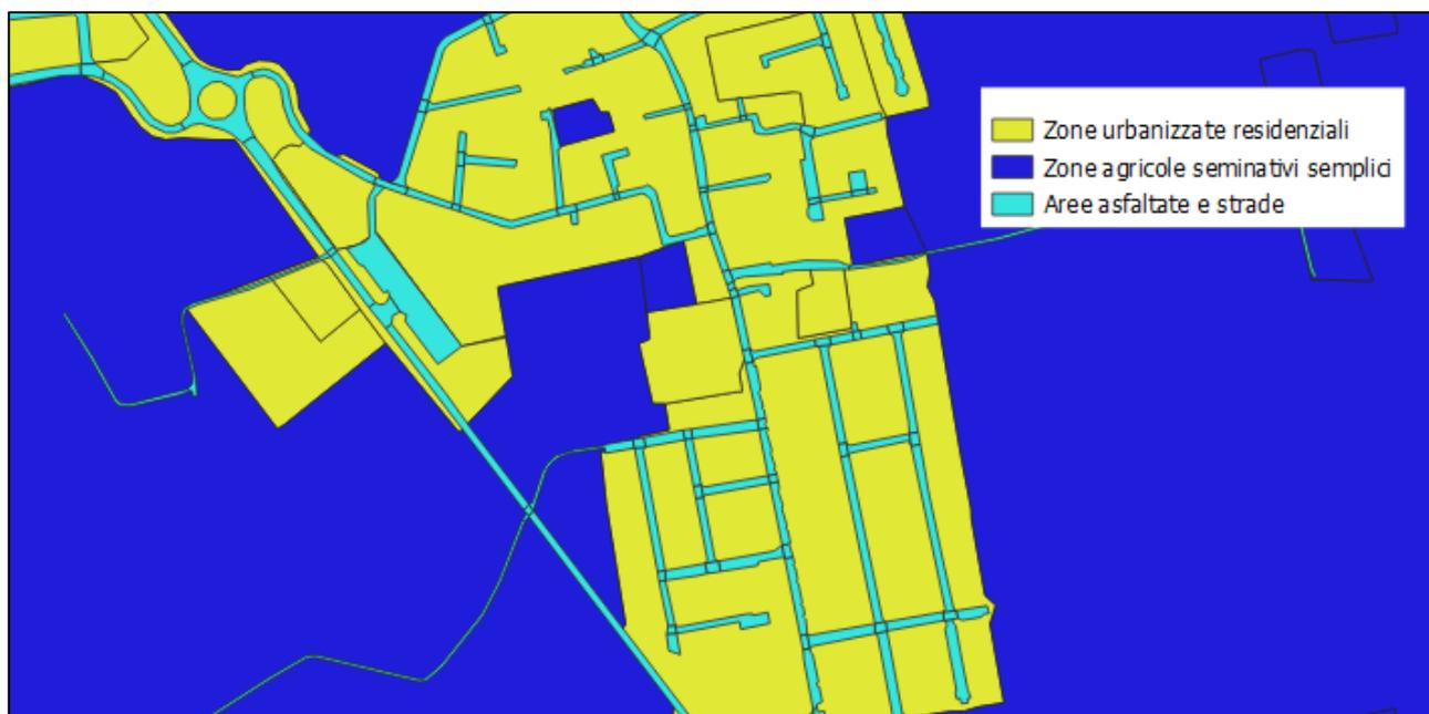
Figura 18. Mappa aree a differente scabrezza implementate nel modello bidimensionale.
