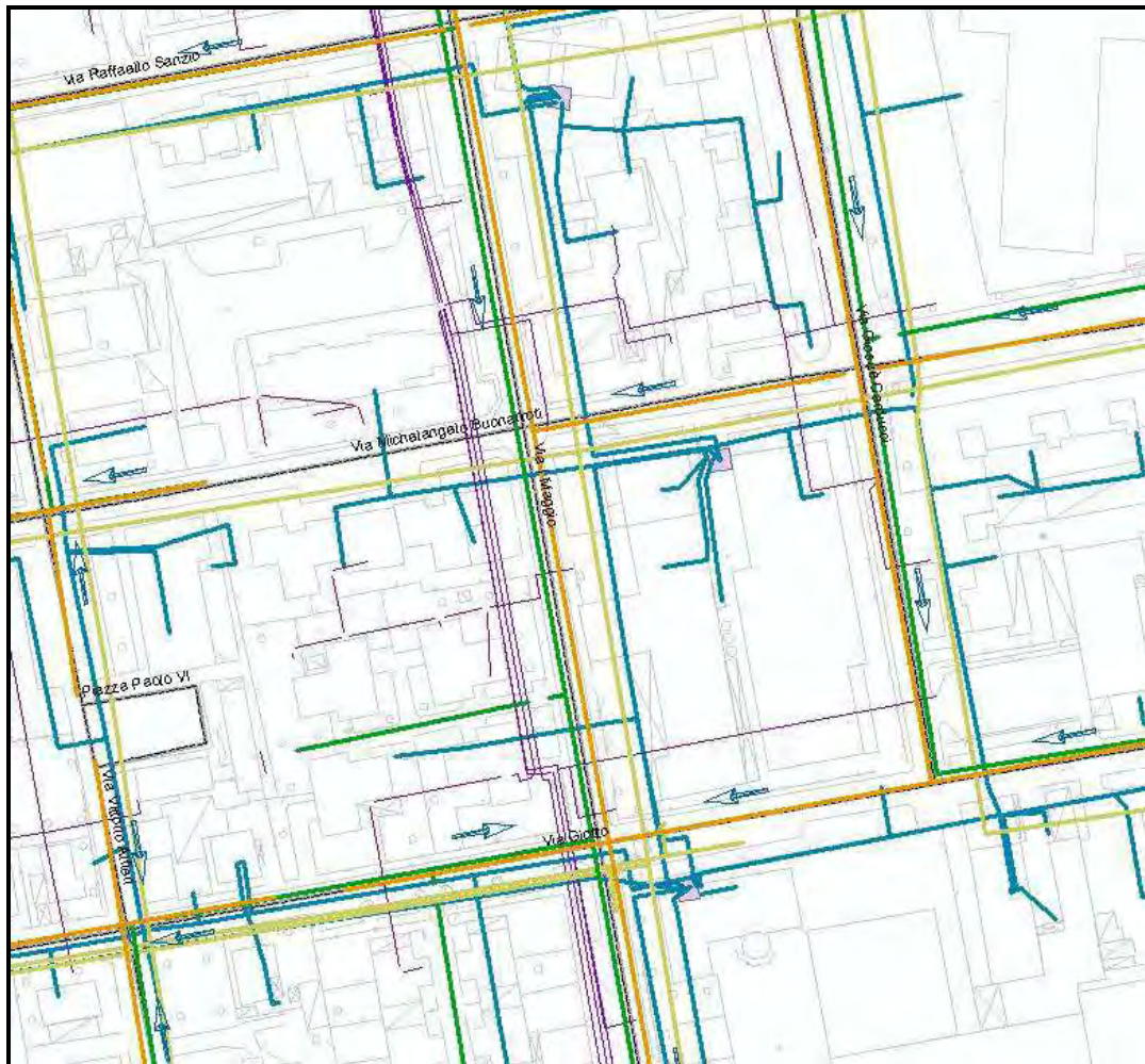
Concentrazione di sottoservizi all'incrocio via Primo Maggio via Buonarroti
